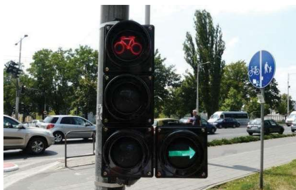
Zdjęcie 50 Sygnalizator S-1a z warunkową strzałką do skrótu w prawo – sygnalizator na końcu kontrapasa rowerowego zapewnia relacje niedostępne dla ruchu samochodowego
