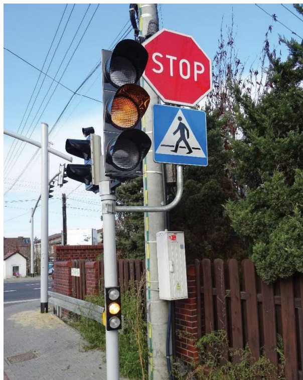
Zdjęcie 51 Sygnalizator pomocniczy o średnicy 100 mm. Polska, Gliwice
